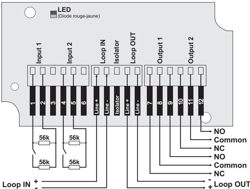
Sans utiliser le module isolateur intégré.
