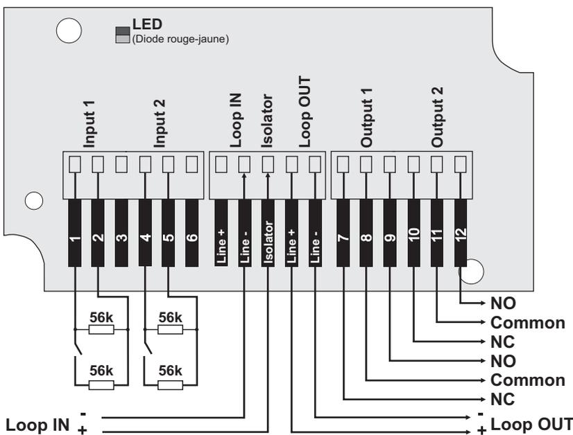
En utilisant le module isolateur intégré.
